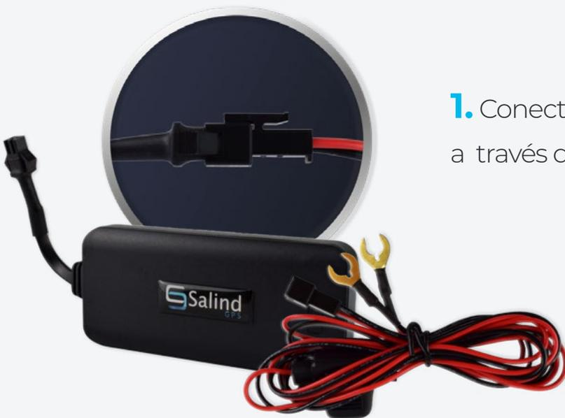
1. Conecte el Salind 01 al arnés de cables a través de la conexión negra.
