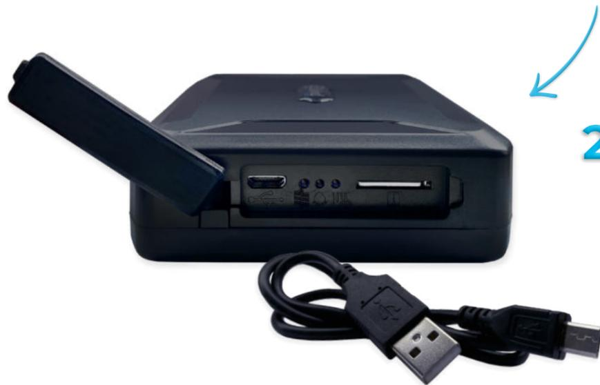
3. Wenn das Ladekabel eingesteckt und mit einer Stromquelle verbunden ist, leuchtet das rote LED Signal. Der GPS Tracker wird nun geladen. Sollte dies nicht der Fall sein, überprüfen Sie bitte ob die SIM Karte richtig eingesteckt ist.
