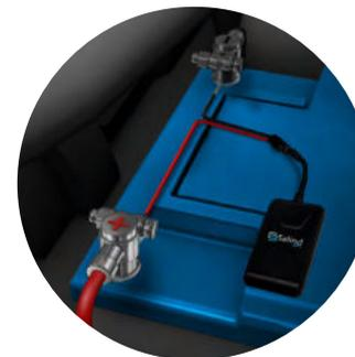
3. Schließen Sie den Tracker an die Batterie an. Das rote Kabel mit der Sicherung an PLUS (+). Das schwarze Kabel an MINUS (-).
