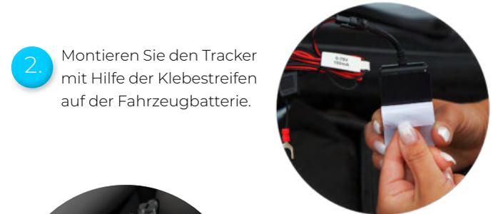
2. Montieren Sie den Tracker mit Hilfe der Klebestreifen auf der Fahrzeugbatterie.
